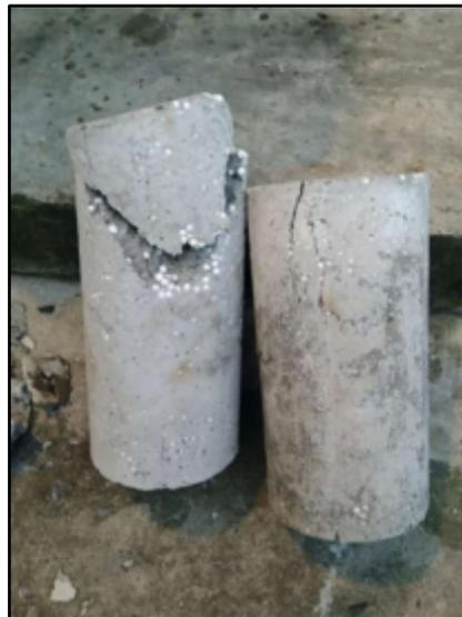
La figura 2, evidencia la aglomeración de perlas de EPS, este mismo efecto se generalizó en las 9 probetas con el porcentaje del 20%
