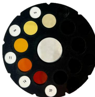
Figura 1(a). Nivel de impureza orgánica de la muestra del río Puca      Figura 2(a). Placa orgánica de colores
