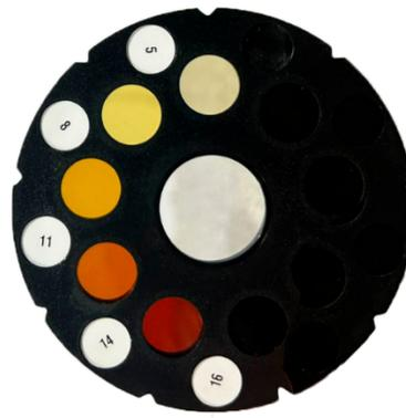
Figura 3(b). Nivel de impureza orgánica de la muestra de banco      Figura 4(b). Placa orgánica de colores
